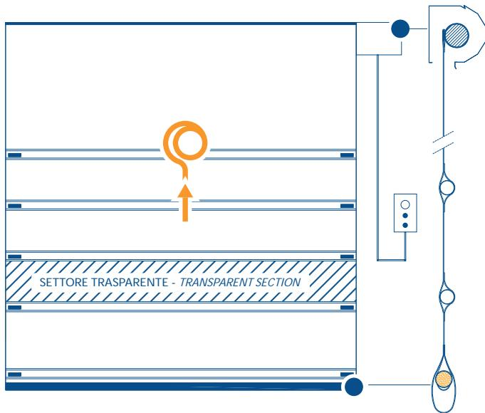
**Struttura:** autoportante in lamiera di acciaio preverniciato, zincata o inox
